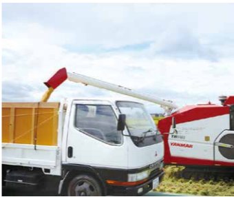
▲コンバインで刈り取った稲から籾を脱穀(だっこく)し、トラックへと詰め込む様子。
