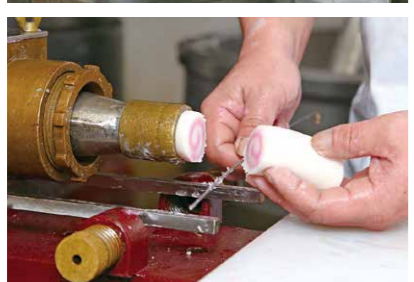
▶箸巻きかまぼこを一定の大きさにカット。このあとストロキーで巻いて型をつけます。
