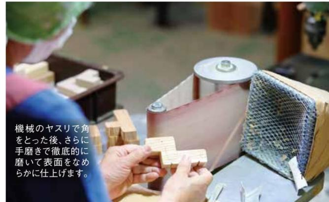
機械のヤスリで角をとった後、さらに手磨きで徹底的に磨いて表面をなめらかに仕上げます。
